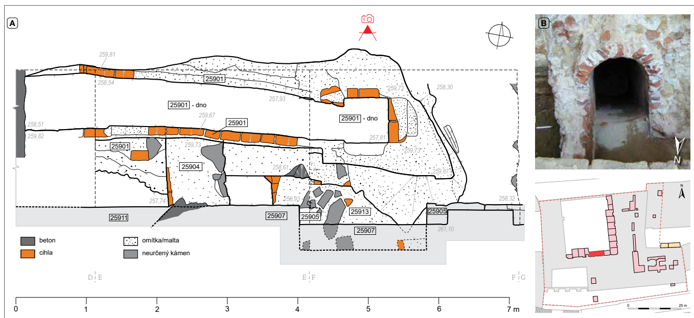
Obr. 56. Praha 1, Hradčanské nám. čp. 185/IV, sonda XV. Cihlová kanalizační štola v místě, kde se stáčí, aby prošla pod jižním křídlem paláce (sestavil F. Adámek, 2024; foto G. Blažková, 2003).
