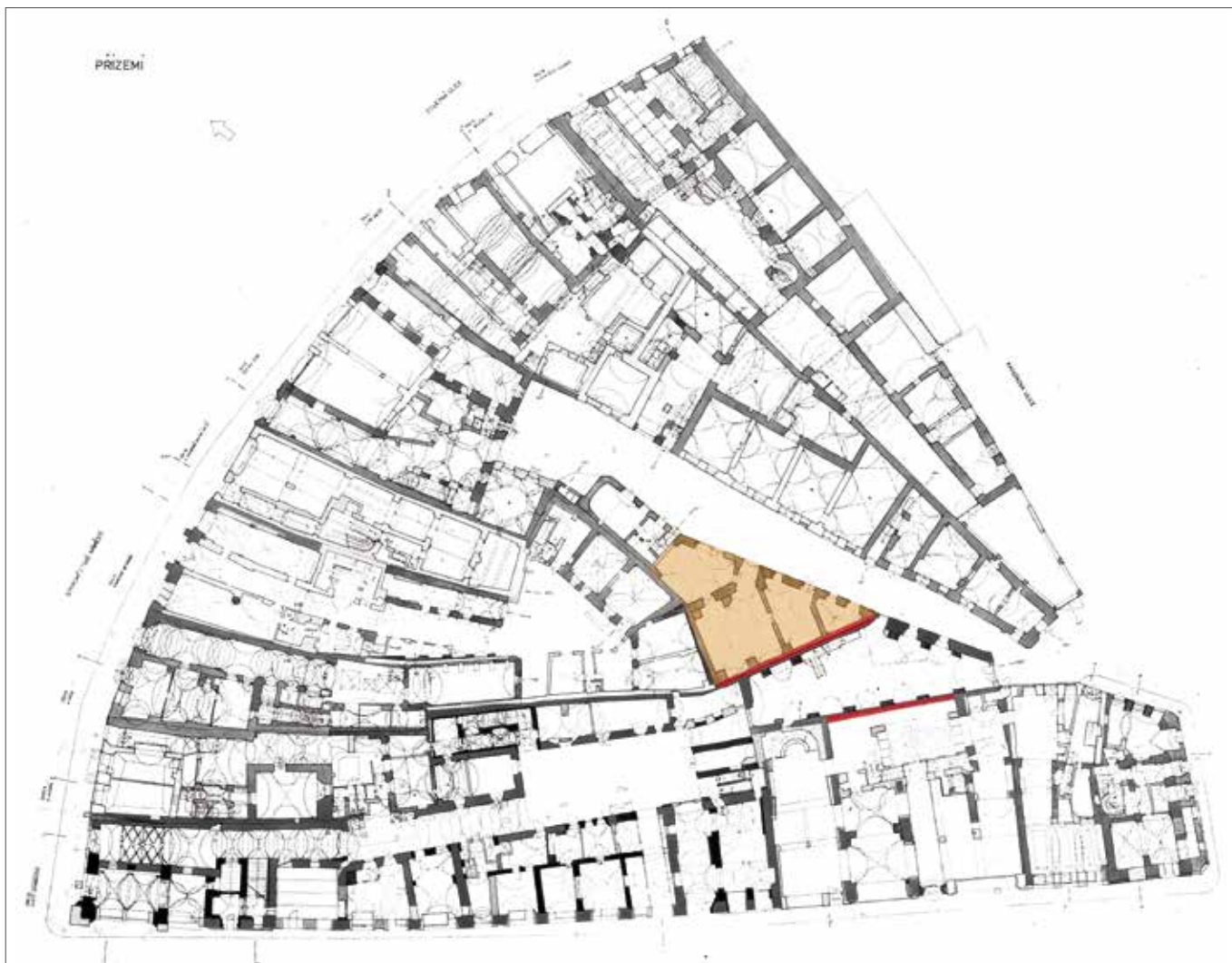
Obr. 9. Celetná čp. 553/I. Západní dvorní objekt. Poloha dvorního křídla (objektu C) vyznačená na výkrese tzv. blokového pasportu přízemí bloku mezi Staroměstským náměstím, Železnou, Kamzíkovou a Celetnou ulicí. Červeně zvýrazněny nově zjištěné raně gotické zdi z břidlic. (Podklad kolektiv autorů SÚRPMO, 1960; úprava L. Bartoš, 2020.)
