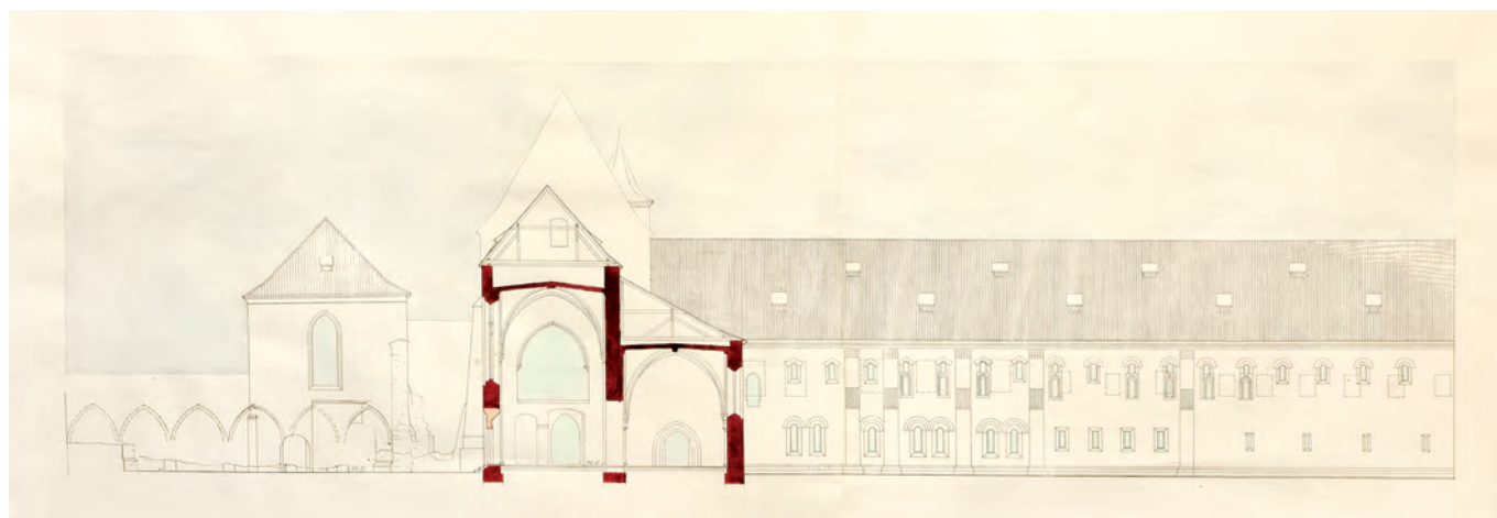
Obr. 5. Praha 1-Staré Město, Anežský klášter. Vpravo východní fasáda konventu klarisek z nejstarší stavební fáze kláštera s charakteristickým cihlovým lícovým zdívem (kolorovaný plán arch. Hyzlera z r. 1964, repro P. Havlík, 2010).
