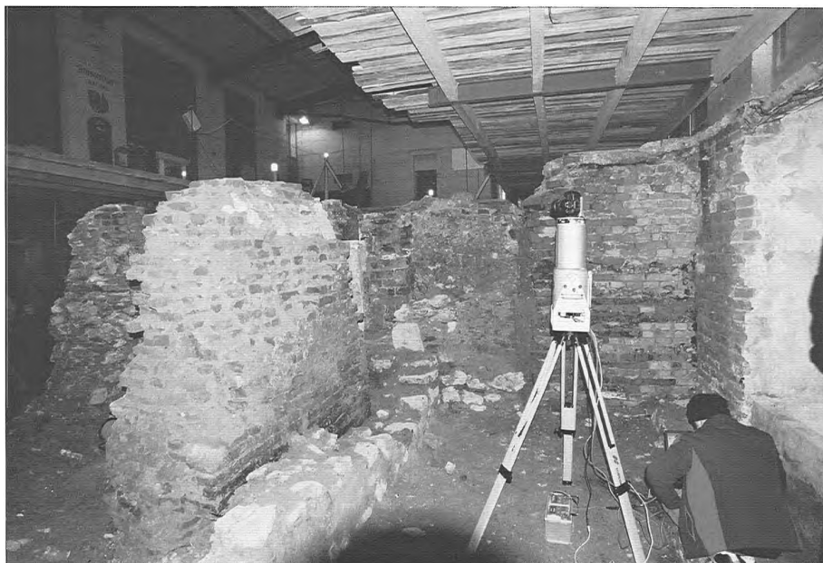
Obr. 4: Dokumentace odkrytého sklepa 3D skenerem firmy GEODIS v prostoru Pánské 6–8 (2003).
