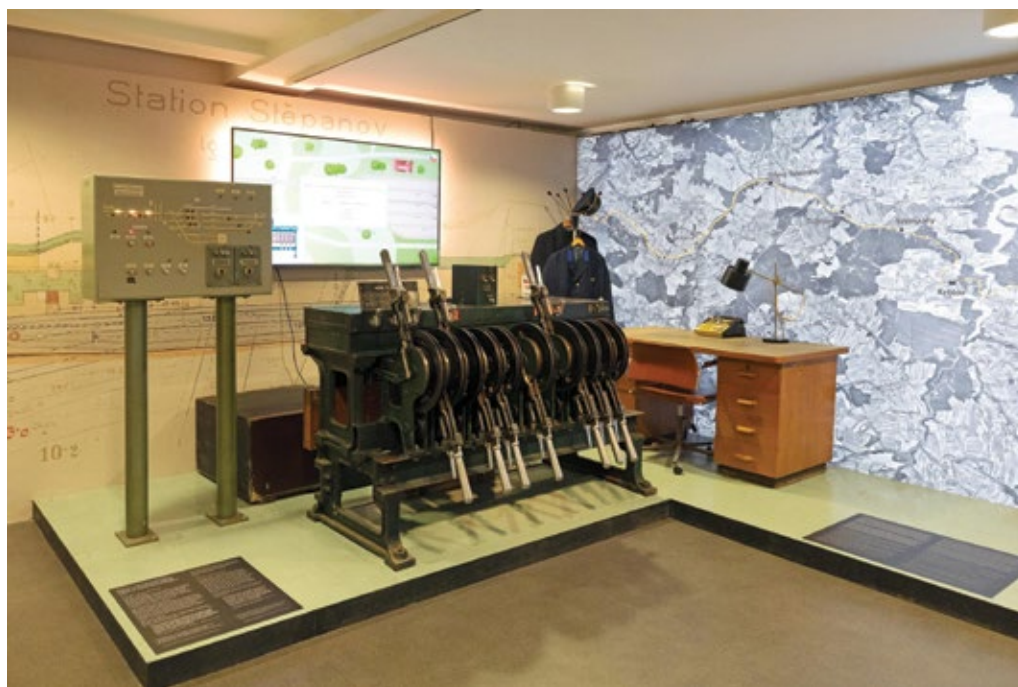
Obr. 5. Interaktivní tzv. Ústřední mechanický stavědlový přístroj se samočinným závěrem výměn ze stanice Trhový Štěpánov – sekce „Staň se na chvíli výpravčím“ (© NTM; foto P. Sláma, 2025).
