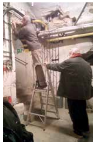
Obr. 7. Praha 1-Staré Město, Staroměstské náměstí čp. 549/I. Odběr vzorku z fošnového překladu portálové niky (foto M. Semerád, 2018).
