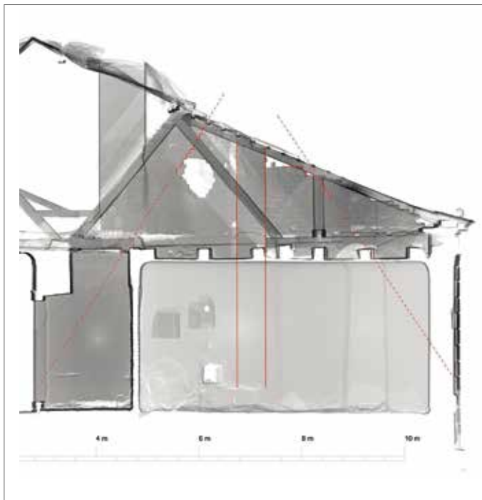
Obr. 7. Praha 1-Staré Město, čp. 219, Liliová 5. Ortogonální pohled na vnější exteriérovou stranu gotického štítu. Výstup z laserového skenování (vyhotovil Zdeněk Marek) – mračno bodů se zákresem vlastního štítu a komínového tělesa. Ve vrcholu patrný relikt zubořezu (zákres M. Semerád, 2018).
