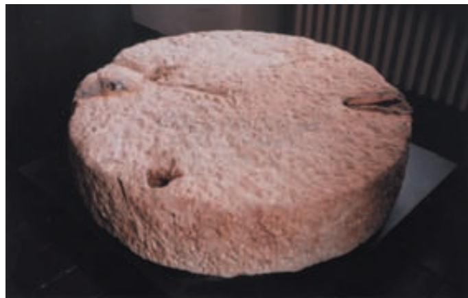
Obr. 4. Praha1-Staré Město, čp. 191, Muzeum Karlova mostu. „Mlýnský kámen“ z karbonské arkózy, vyzdvížený v roce 2005 ze základu pilíře č. 8 Karlova mostu (foto V. Rybařík, 2006).
